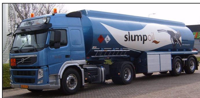
Stikstof in banden, extra hoge cabines, aluminium velgen, TRAXX diesel en Castrol Low-SAPS motorolie maken deel uit van de maatregelen van Slump Oil om haar brandstofverbruik te reduceren.
